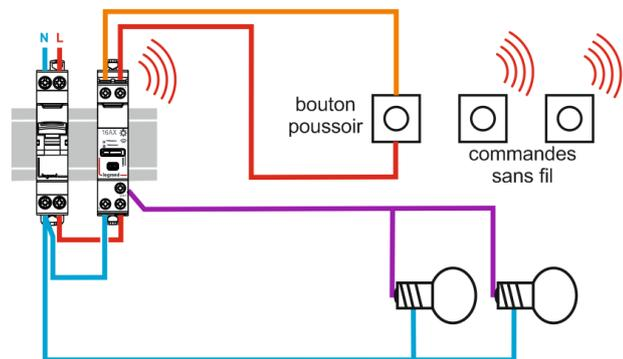
. Installation sans fil avec plusieurs commandes sans fil « ... with Netatmo » pilotant un télerupteur :
