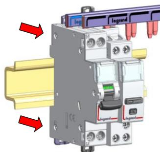
2. Tirer l'appareil vers l'avant afin de le dégager du rail
