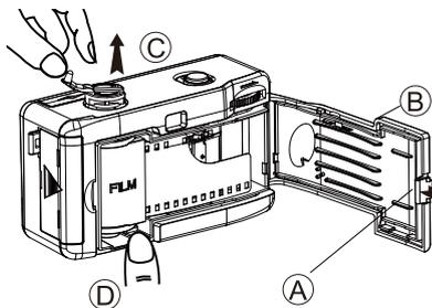
Appuyer sur le loquet (A) dans le sens de la flèche et ouvrir la porte arrière de la caméra (B). Remontez la manivelle (C) et placez un nouveau rouleau de film dans la chambre de film.
