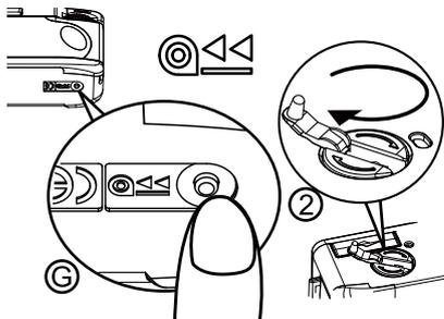
Une fois toutes les photos prises, appuyez sur le bouton de rembobinage (G) situé au bas de l'appareil photo, tournez la manivelle de rembobinage du film dans le sens des aiguilles d'une montre jusqu'à ce que tout le film soit remis dans la cartouche de film.
